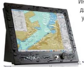
Индекс IP используется для указания уровня защиты устройства от воздействия окружающей среды. IP-индекс состоит из двух цифр. Первая цифра указывает защиту от попадания твердых предметов, а вторая — защита от попадания жидкостей. Чем больше
